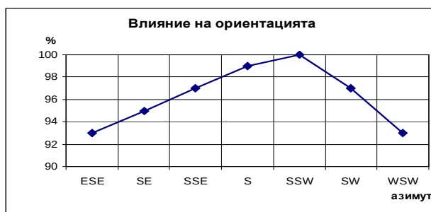
Фиг.18. Влияние на ориентацията върху количеството на преобразуваната слънчева енергия
